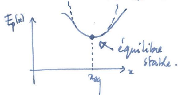
l'énergie croît en allant vers les  $x < x_{\text{eq}}$ , i.e.  $E_p$  est une fonction décroissante.
