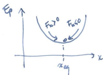
$$E_p(x) \underset{x \approx x_{\text{eq}}}{\approx} E_p(x_{\text{eq}}) + \underbrace{\frac{1}{2} E_p''(x_{\text{eq}}) \cdot (x - x_{\text{eq}})^2}_{\text{énergie d'oscillation harmonique}}$$
