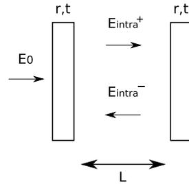
♣ (a) Exprimer le rapport de l'intensité intracavité sur l'intensité incidente  $G = I_{\text{intra}}^+ / I_0$  et le représenter en fonction de  $\varphi = 2kL$ . Faire apparaître la finesse  $\mathcal{F}$  de l'appareil. (\* Ordre de grandeur de  $\mathcal{F}$  pour un interféromètre de (haute) précision ? \*)
