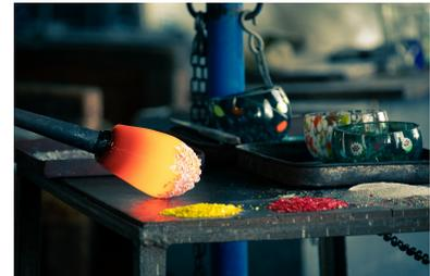
FIGURE 10.4: L'ajout d'additifs permet de colorer la pâte de verre chaude.
