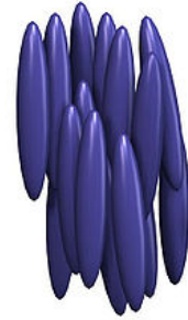
FIGURE 11.3 – Dans la phase nématique, les constituants partagent la même orientation, aux fluctuations thermiques près.
