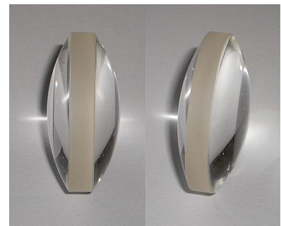
FIGURE 12.1 – Une lentille convergente, réalisée en polissant les faces à l'intérieur de sphères abrasives. Crédits photo : Tamasflex
