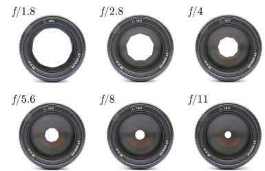
FIGURE 12.7 – Diaphragme pour les ouvertures f/1.8, f/4, f/11 , qui correspondent à un nombre d'ouverture N = 1.8, N = 4 et N = 11 .
