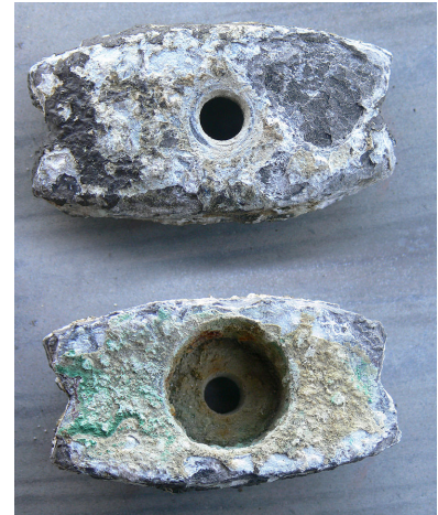
FIGURE 1.7: Cette anode sacrificielle est en partie corrodée : mieux vaut que ce soit elle que la coque du bateau!
