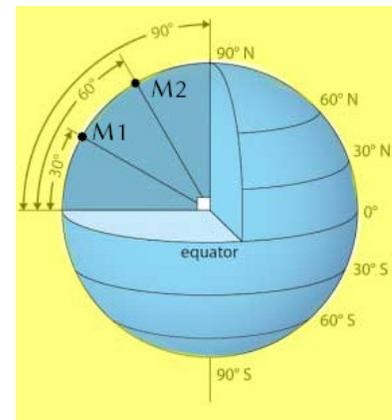
FIGURE 4.2: Vue en coupe du méridien terrestre qui contient les deux points  $M_1$  et  $M_2$ . Leur distance à vol d'oiseau  $d_{12} = R_T |\phi_1 - \phi_2|$ . Où les latitudes  $\phi_1$  et  $\phi_2$  sont **exprimées en radians**
