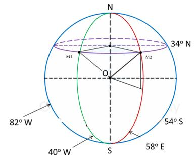
FIGURE 4.4: Cette vue du méridien en coupe nous permet d'illustrer que  $r(\phi) = R_T \cos(\phi)$
