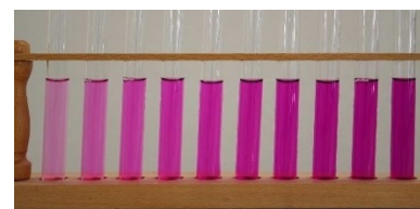
FIGURE 4.2: Une gamme de solutions étalon utilisée pour un dosage par comparaison.
