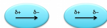
FIGURE 1.5: Schéma de principe interaction dipole/dipole Van der Waals : les charges partielles de signe opposé sont plus proches que les charges partielles de même signe, si bien que l'interaction résultante est attractive . D'après Culture Sciences
