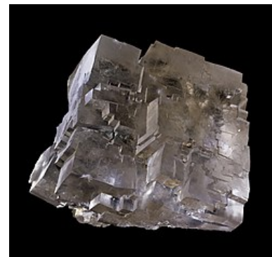
FIGURE 1.1: Le chlorure de sodium (NaCl) est un solide cristallin, qui se scinde le long de facettes régulières
