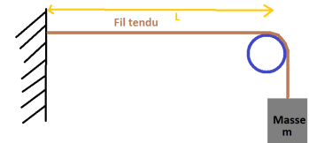
FIGURE 4.5: Tension d'un fil lorsqu'on tire dessus. La poulie permet de dévier cette tension : elle en change la direction sans en changer la norme.
