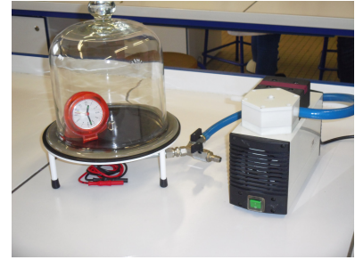
FIGURE 6.3: Le son ne se propage pas dans le vide : si l'on place un réveil qui sonne dans une cloche à vide, on peut étouffer le son en retirant l'air de la cloche! Vidéo sur la chaîne Unisciel
