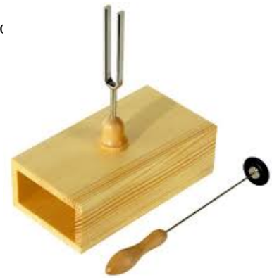
FIGURE 6.4: Un diapason est mis en vibration au moyen d'un marteau (l'ensemble constitue la source sonore). Le volume est alors très faible, jusqu'à ce qu'on mette le diapason au contact d'une caisse de résonance. Le volume sonore augmente alors très nettement. Vidéo du phénomène sur le site d' Unisciel
