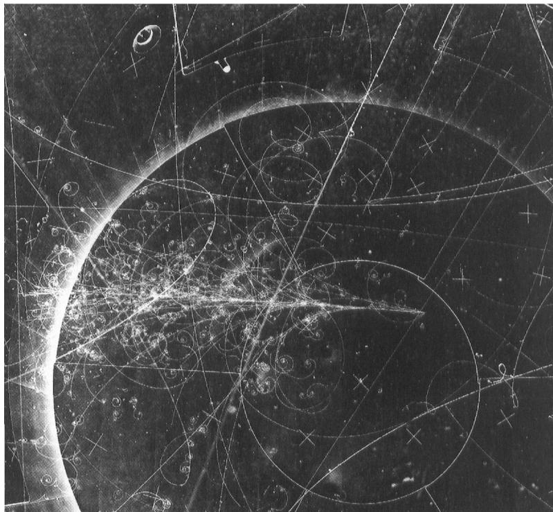
FIGURE 1 – Traces laissées par des particules dans une chambre à bulles.
